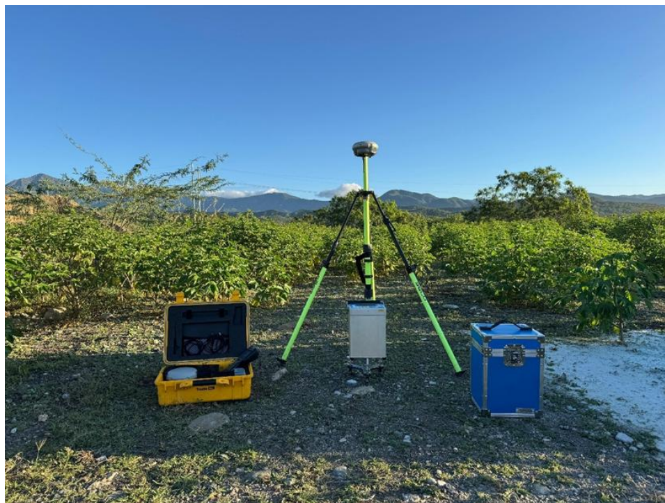
Manera correcta de realizar las mediciones gravimétricas y de GNSS
